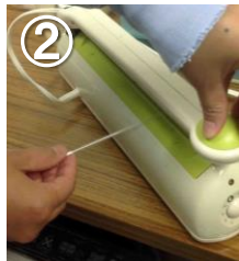
ストロー管の先端をシーリング。
